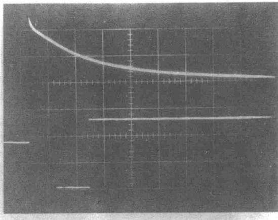
Abb. 19. Oszillogramm des zeitlichen Stromverlaufs (obere Kurve) beim potentiostatischen Einschalten einer konstanten Überspannung von  $-255$  mV für die Wasserstoffabscheidung an Kupfer aus  $0.5$  m Schwefelsäure. Zeitskala:  $20$  msec/Einheit, Strom:  $0.2$  mA/Einheit. Untere Kurve: Spannungsimpuls ( $0.1$  V/Einheit). Die Nullpunkte der Zeitskala für die beiden Kurven sind gegeneinander verschoben.
